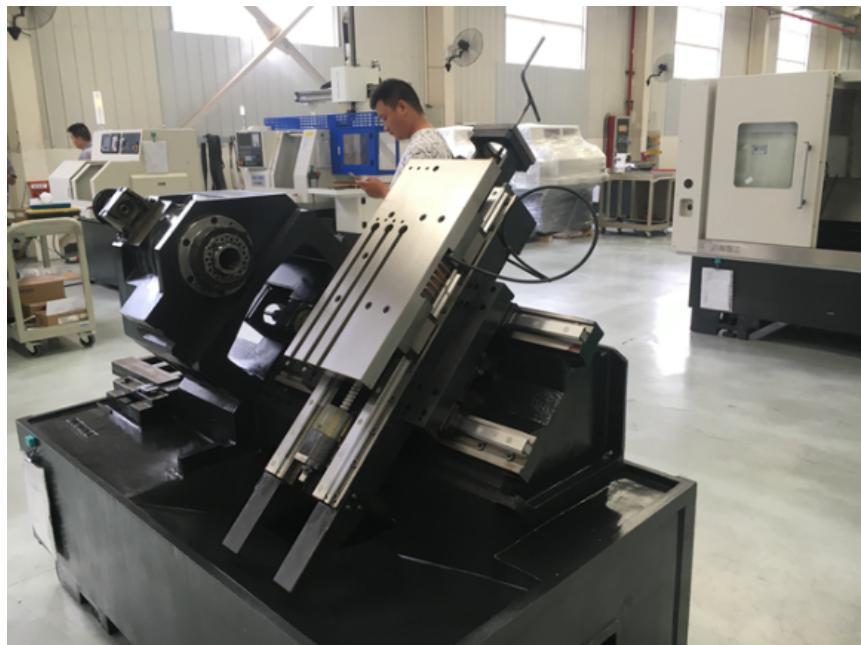
数控机床加工原理：1、机床本体数控机床的机床本体与传统机床相似，由主轴传动装置、进给传动装置、床身、工作台以及辅助运动装置、液压气动系统、润滑系统、冷却装置等组成。2、CNC单元CNC单元是数控机床的关键。CNC单元由信息的输入、处理和输出三个部分组成。3、输入/输出设备输入装置将各种加工信息传递于计算机的外部设备。4、伺服单元伺服单元由驱动器、驱动电机组成，并与机床上的执行部件和机械传动部件组成数控机床的进给系统。
